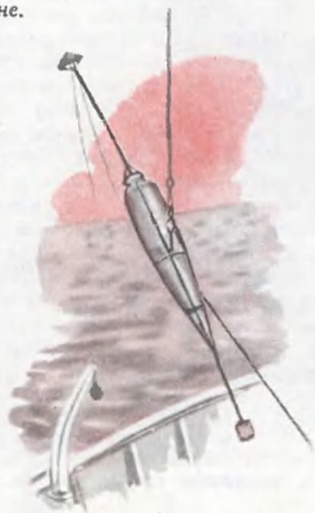
Буй для якорных и дрейфующих буйковых станций. Эти станции остаются одни в океане и сообщают на судно данные о направлении и скорости течений.
